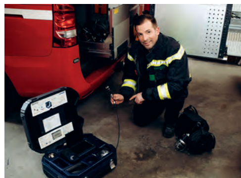
Die Kamera dient zur optischen Inspektion und Dokumentation.
