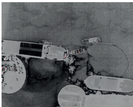
... machte mit der Wärmebildkamera Aufnahmen der Ölschlieren.
