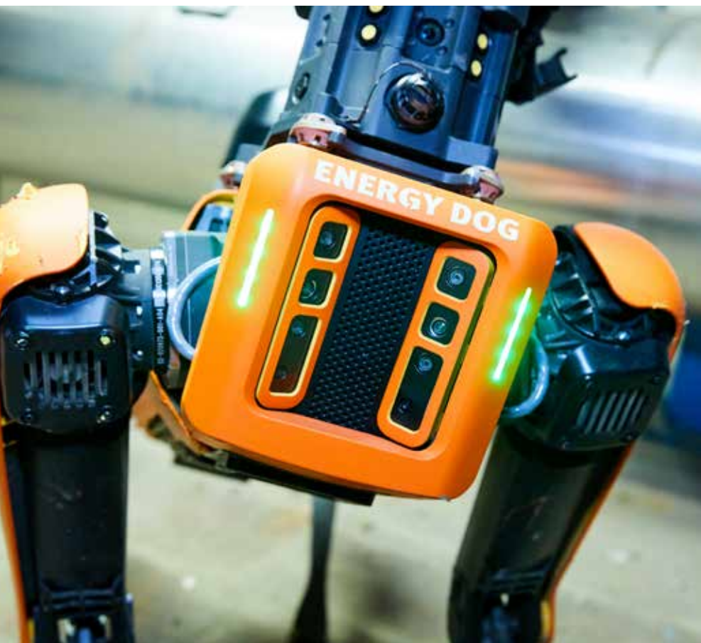
Mit dem Laser-Scanner erkennt der „Energy Dog“ Hindernisse, sein Akku hält circa 90 Minuten.
