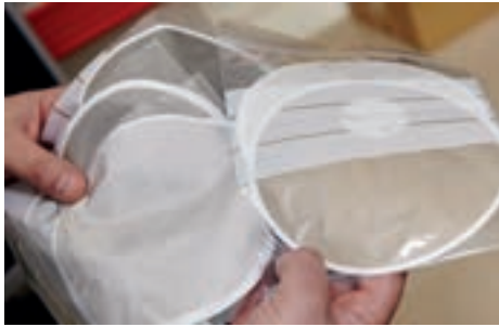
Einzelne Messscheiben als Beispiele. Auf der rechten Scheibe wurde Sand aus der Sahara „eingefangen“.
