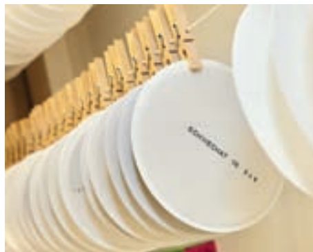
Mit diesen Messscheiben wird der Feinstaub kontrolliert. Umso dunkler, umso schlechter die Werte.
